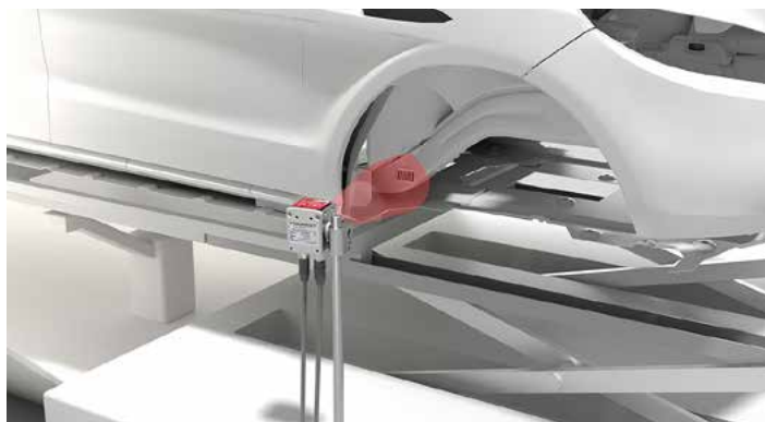
I lettori di codici basati su telecamera che utilizzano identCHAIN non solo forniscono l'identificazione dei singoli oggetti, ma anche informazioni sul dispositivo e sullo stato per ogni fase di produzione.
